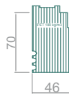
HW1033 U=0,84 W/m²K Aluplast Energeto Neo Aluplast Ideal 8000 Drutex Iglo Energy REHAU 86 REHAU Geneo Schüco Corona 70 Schüco Living 82
